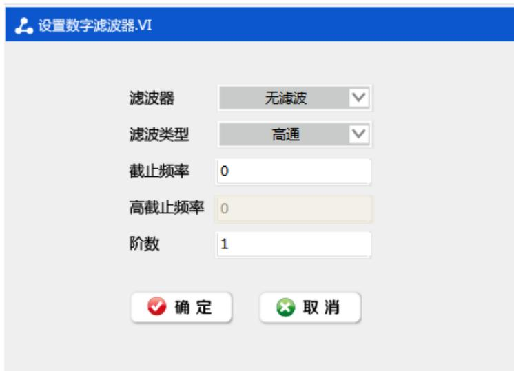
【Butterworth 滤波器】：又称最大平坦型滤波器，通过内幅频曲线的幅度平坦，最平幅度逼近，相移与频率的关系不是很线性的，阶跃响应有过冲。
