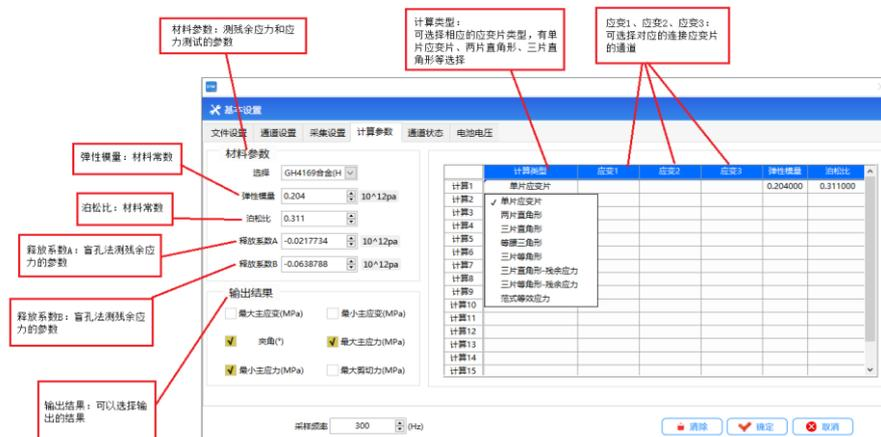
材料参数：测残余应力和应力测试的参数。
