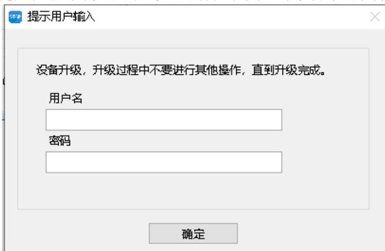
在主界面的工具栏里，选择设备升级按键，弹出用户输入对话框，提示输入用户名和密码，用户名：admin 密码：123456，输入正确后可进行升级界面。选择主机的升级程序，填入升级程序的路径，然后点击主机升级/终端升级按键，即可进行程序升级。升级过程中会有两个进度条，一个是程序的下发进度，下发完成后，开始程序升级，这时会显示升级进度。等进度完成后，即完成了设备的升级工作。
