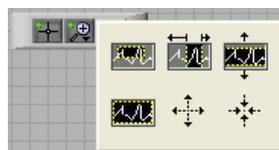
**数据导出小技巧：**如果想把曲线上显示的波形导入 Excel，在曲线显示框选择右击，导出-导出至 Excel 即可。导出只是导出在显示出来的区域，可以通过波形工具栏移动来选择需要的波形。
